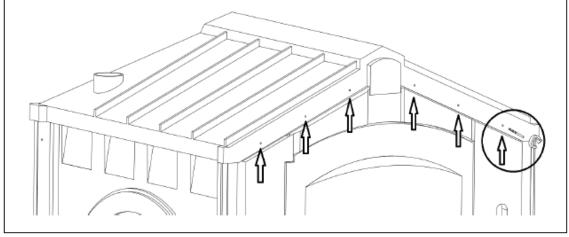
3.20. Просверлить 15 отверстий в крыше и трех боковых панелях (по 5 отверстий на каждую сторону), ориентируясь на специальные ребра жесткости, и закрепить вытяжными заклепками (4,8х18 мм) с шайбой:
