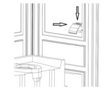
3.13. На внутренней стороне передней лицевой панели, просверлить отверстия для закрепления задвижки и крючка для одежды. Заклепать крючок и задвижку лепестковыми заклепками (4,8х21 мм):
