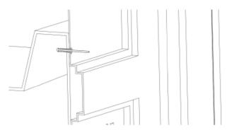
3.12. Просверлить два отверстия диаметром 5 мм в бумагодержателе и боковой панели. Закрепить бумагодержатель на боковой панели с помощью вытяжных заклепок (4,8x18 мм):
