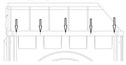
3.21. Просверлить отверстия в двери и закрепить лепестковыми заклепками (4,8х21 мм) проушину для замка. Вторую проушину закрепить таким же образом на арке:
