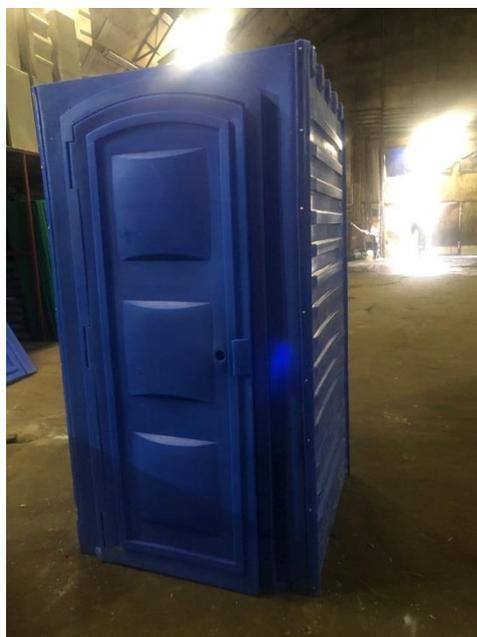
6. Далее с внутренней стороны кабины скрепить заклепками передние 2 (два) ребра кабины (примерно по 6 клепок на ребро).
