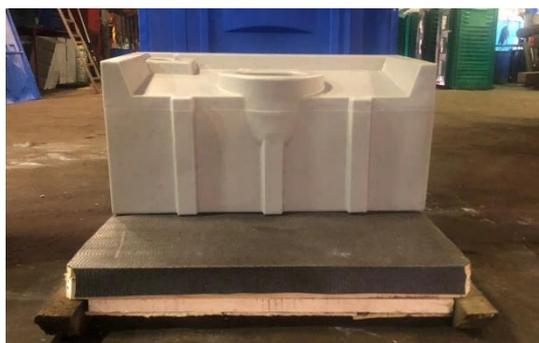
8. Установить каркас кабины на туалетный поддон с баком, при этом оттягивая стенки кабины с помощью рычага воздействия.
